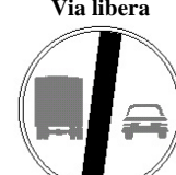
Fine del divieto di sorpasso per i veicoli di massa a pieno carico superiore a 3,5 tonnellate
