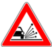
Materiale instabile sulla strada
